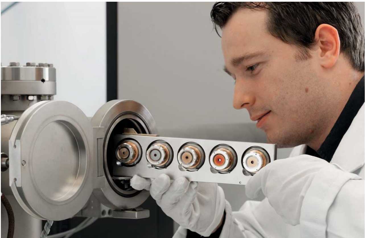
Forscher analysieren die neue Stahl-Legierung auf chemische Veränderungen der Oberflächen für den Einsatz in der Brennstoffzelle (SOFC).
