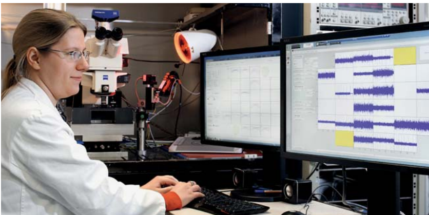
Aufzeichnung der für Herzmuskelzellen typischen Ausbreitung von elektrischen Aktionspotenzialen.
