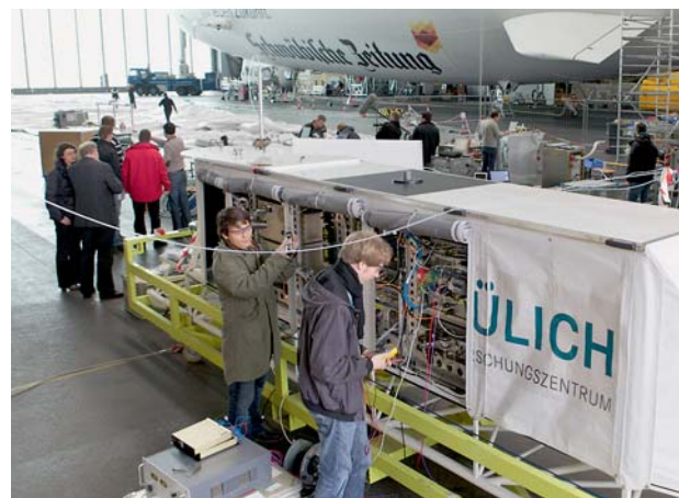
Jülicher Klimaforscher bestücken die Top-Plattform mit Instrumenten. Sie sitzt oben auf dem Zeppelin und sammelt Daten zur Selbstreinigungskraft der Atmosphäre.
