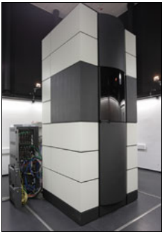
DAS FAST FÜNF METER HOHE ELEKTROENMIKROSKOP PICO STEHT AUF EINEM LUFTFEDERGEDÄMPFTEN 200-TONNEN-SCHWEREN BETONFUNDAMENT, DAMIT ES VOR ALLEN ERSCÜTTERUNGEN BIS IN DEN MIKROMETERBEREICH GESCHÜTZT IST. QUELLE: FORSCHUNGSZENTRUM
